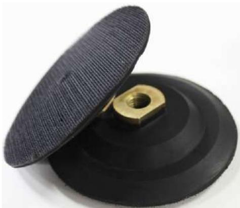
Prato totalmente de borracha com engate universal M-14 para lixas de polimento úmido/seco de 100mm. A borracha macia do prato facilita o polimento quando é aplicada uma leve pressão em algumas partes da pedra ou em partes irregulares.
